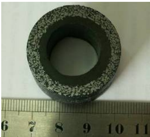
Рис. 4. Загальний вигляд зразків, отриманих відцентровим ушільненням
