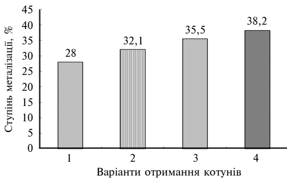
Рис. 2. Ступінь металізації котунів основністю 1,4 з підвищеним вмістом твердого палива, отриманих за чотирима варіантами і випалених протягом 8 хв (2, 3) і 10 хв (1, 4) за температури 1593–1598 К: 1 – вміст твердого палива 10 % [2]; 2 – вміст твердого палива в пошаровій системі 12 % (40 % цього палива змішується з сировинними шихтовими компонентами, 40 % наноситься на поверхню сирих гранул з імітацією процесу барабанного згрудкування, а 20 % залишкового палива міститься в міжгранульному просторі); 3 – вміст твердого палива всередині гранул 12 % і 3,3 % у міжгранульному просторі (розрахунок від маси гранул); 4 – вміст твердого палива всередині гранул 12 % і 3,3 % у міжгранульному просторі з наявністю на їх поверхні захисного шару із суміші негашеного вапна і залізородного концентрату
